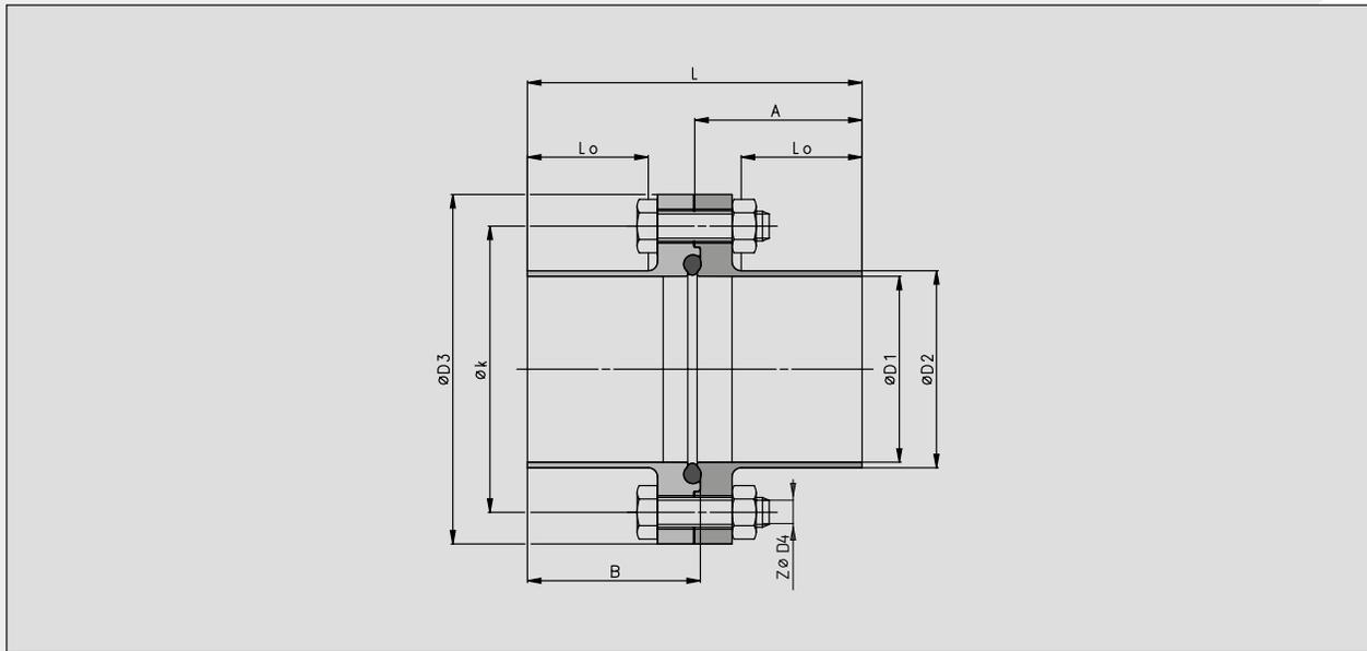
Flange Connection DIN 11864-2 / Flanschverbindung DIN 11864-2
