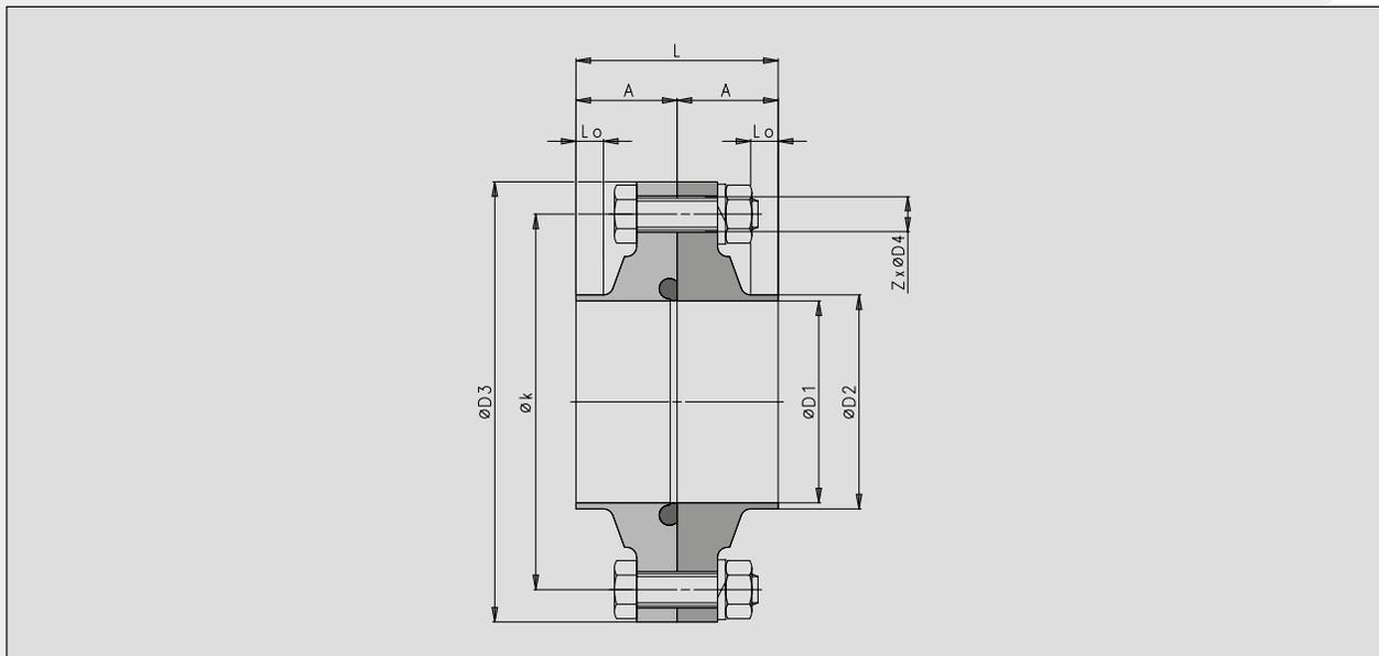
Small Flange Connections V 140 / Kleinflanschverbindungen V 140
