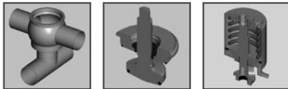
**Hyg. Cross Valve** (EPDM)**Hyg. Kreuzventil** (EPDM)**Select S372** (pneumatic air to open-spring to close / pneumatisch luftöffnend-federschließend)
