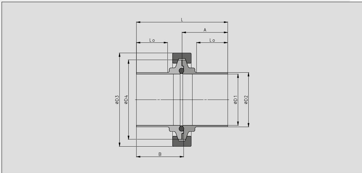
Clamp Connection DIN 11864-3 / Klemmverbindung DIN 11864-3
