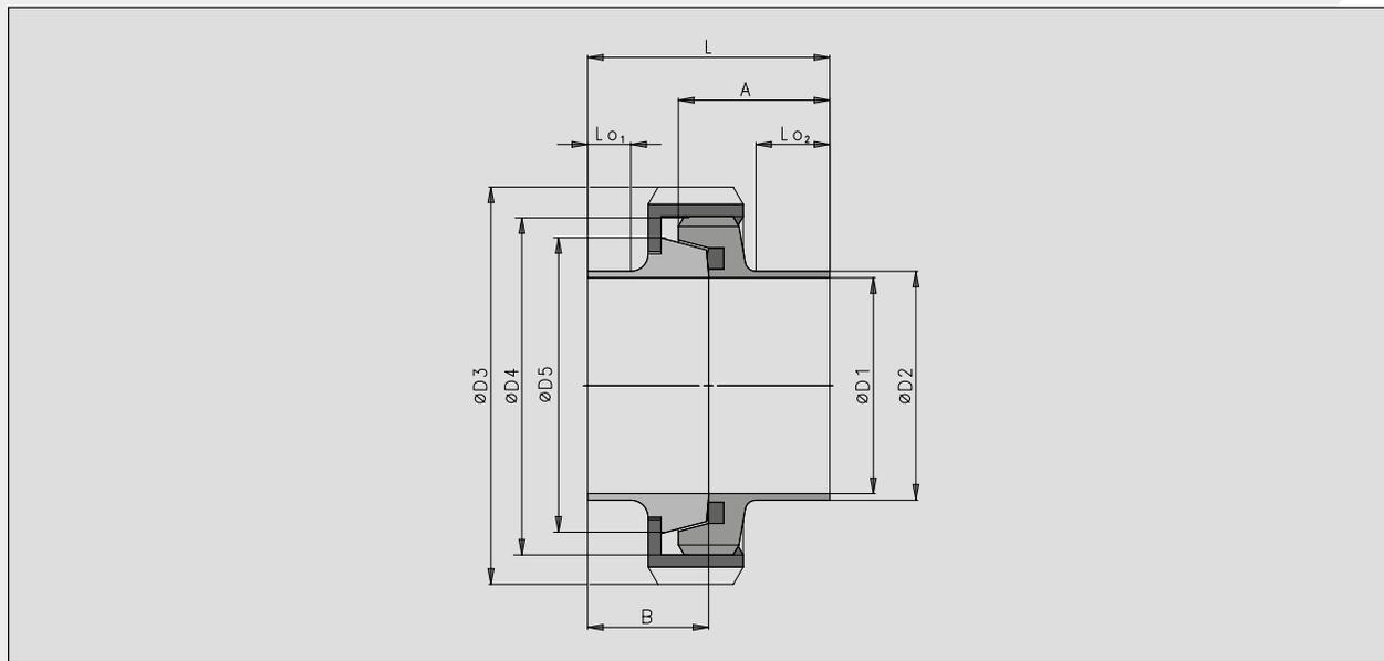
Threaded Connection DIN 11851-SC / Verschraubung DIN 11851-SC
