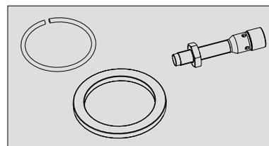
**Clamp for Connection of Valve Housings / Lanterns****Klemme für Verbindung von Ventilgehäusen / Laternen**
