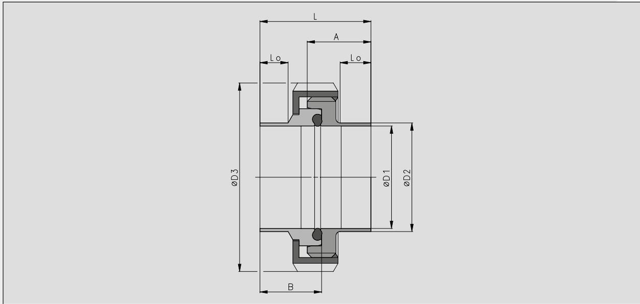
Threaded Connections DIN 11853-1 / Verschraubungen DIN 11853-1
