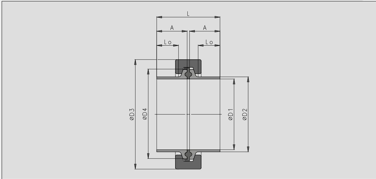
Clamp Connections DIN 32676 / Klemmverbindungen DIN 32676
