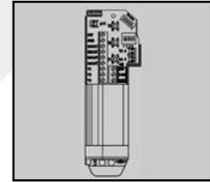
**Position Measuring System Incl. LED Optical Fiber Plate****Wegmesssystem inkl. LED-Lichtleiterplatte**
